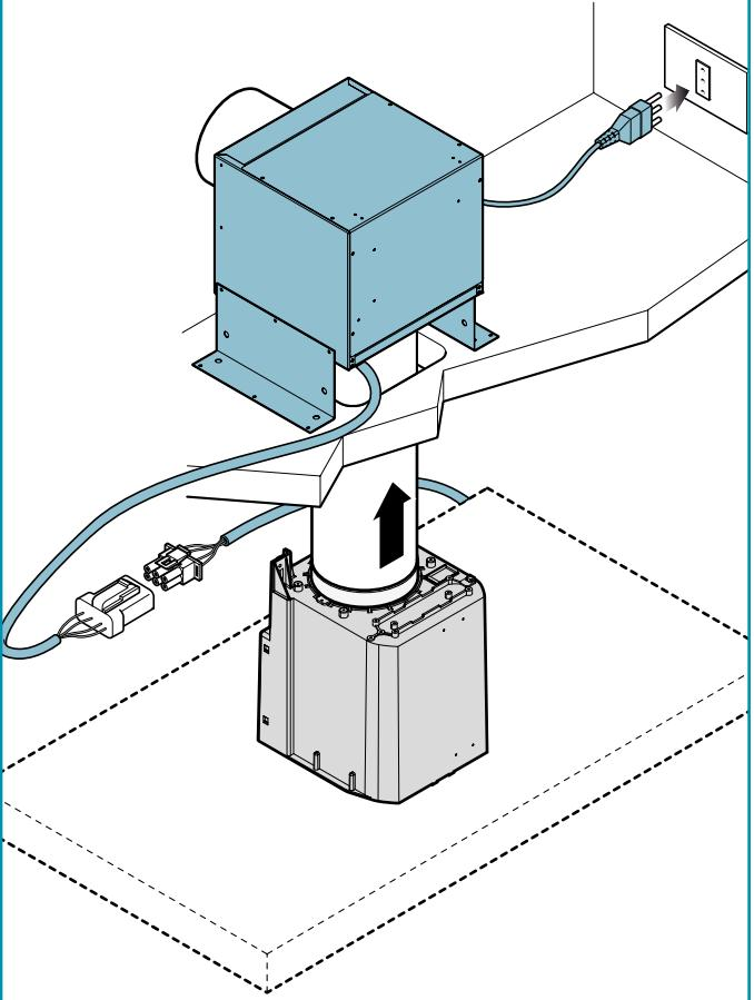
IT - Motore remoto esterno: installazione con cappe a soffitto (12), worktop (13), a parete (14) a isola (15).
